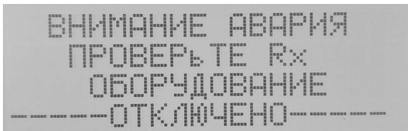
При этом полностью отключается подача хим. реагентов. Для восстановления работоспособности, необходимо выключить устройство, устранить причину аварийной ситуации, включить и сбросить аварию в главном меню выбрав соответствующий пункт:
