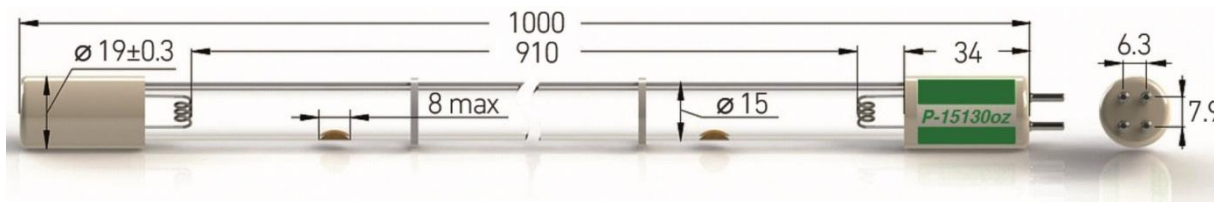
Рисунок 3. Внешний вид ультрафиолетовой двухдиапазонной лампы P-15130oz.
