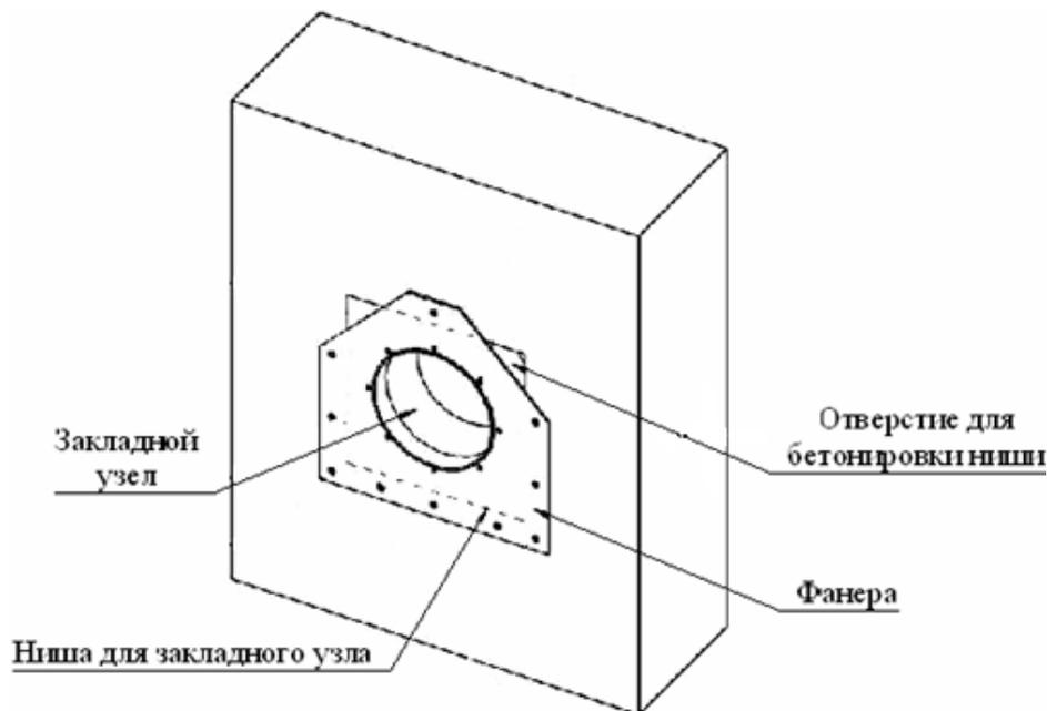
Далее выполните монтаж корпуса распаячного в соответствии со схемами, изображенными на рис. 13-14 в следующем порядке:
