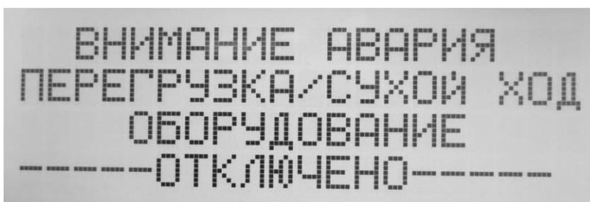
**Примечание: В случае "Сухого хода", пульт управления «PoolStyle PCU-1P», перед тем как выйти в режим аварии, три раза попытается прокачать насос фильтровальной установки.**
