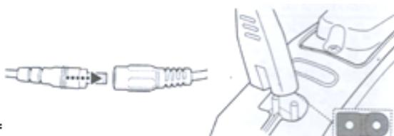
3. Подключите внешний адаптер к источнику питания. Как только робот начнет заряжаться, индикатор на внешнем адаптере загорится красным. Обычно для достижения полной зарядки требуется около 4,5-5 часов. Когда пылесос будет почти полностью заряжен, индикатор загорится зеленым.
