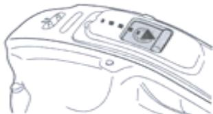
2. Подключите кабель адаптера к зарядному кабелю. Выровняйте и вставьте вилку зарядного кабеля в зарядный порт в верхней части устройства.
