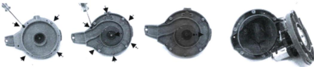
3. Выньте аккумуляторный блок, чтобы открыть РСВА. Чтобы отсоединить провод подключения аккумулятора, нажмите на зажим на разъеме, а затем вытяните его. ПРИМЕЧАНИЕ. Немедленно оберните разъем изоляционной лентой, чтобы избежать короткого замыкания, вызванного контактом обоих клемм.
